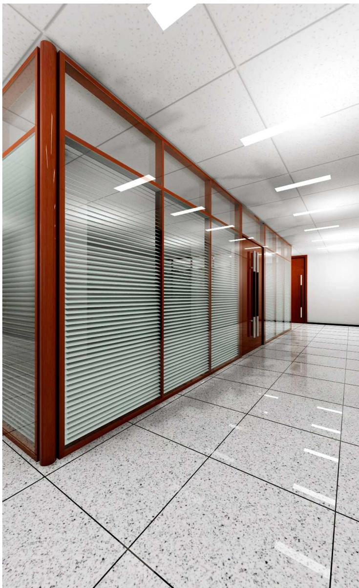
产品原材料组合：高精级铝合金挤出型材，符合国家建筑装饰材料标准，其中内部龙骨材质为铝合金GB 6061 纬氏硬度14°，外部装饰铝材材质为铝合金GB 6063-T5纬氏硬度11°；表板材质由汽车级浮法玻璃、三聚氢胺板、防火板、硅酸钙板、石膏板等材料组成；内置手动及电控铝制模式百叶帘；
